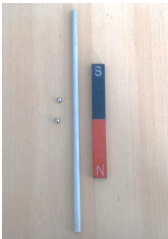
Propustite kroz aluminijsku cijev čeličnu a za njom i magnetnu kuglicu.
